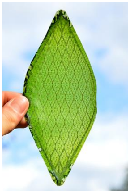
ภาพที่ 1 ใบไม้เทียมผลิตจากการผสม chloroplasts กับใยไหม [3]
