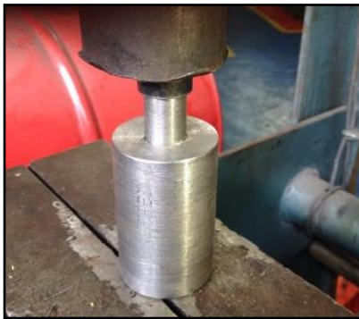
รูปที่ 1 แสดงกระบอกอัดขนาดความโต 20 มิลลิเมตร
