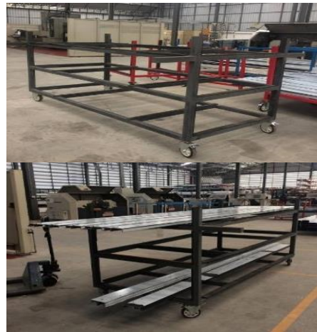
รูปที่ 11. การสร้างรถเข็นเพื่อช่วยจัดกลุ่มสินค้าก่อนเข้าสู่ กระบวนการประกอบ
