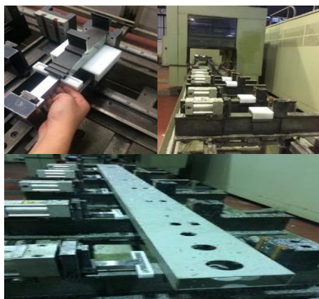
รูปที่ 10. อุปกรณ์จับยึดที่ใช้กับเครื่อง CNC
