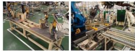
รูปที่ 13 การวางตำแหน่งอุปกรณ์จับยึดประกอบและตำแหน่งรางเลื่อน
