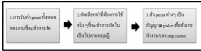
รูปที่ 13 องค์ประกอบของโปรแกรมควบคุมเครื่องกัด
