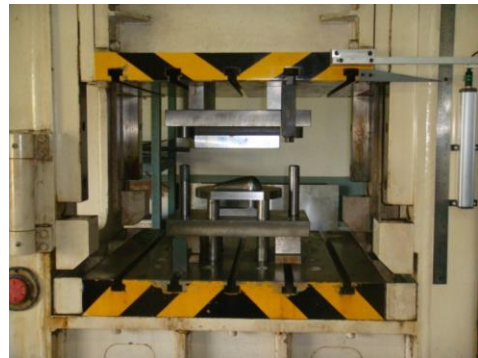
รูปที่ 6 การติดตั้งแม่พิมพ์บนเครื่องปั๊มไฮดรอลิกส์ 80 ตัน
