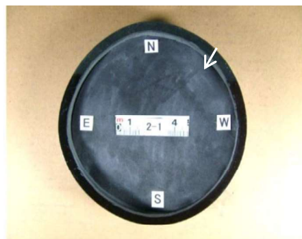
รูปที่ 2 ชั้นของคาร์บูไรเซชันจากด้านในหลังกัดกรด[5]
