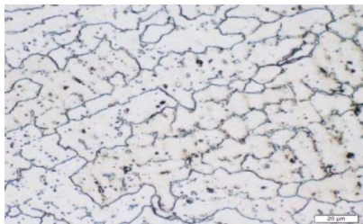
รูปที่ 9 โครงสร้างจุลภาคชิ้นงานที่มีการสั่นแบบอัลตราโซนิกกำลังขยาย 500 เท่า
