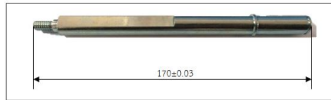
รูปที่ 3 ชิ้นงานสลักเพล (Pin Shaft) ที่ต้องทำการตรวจสอบ
