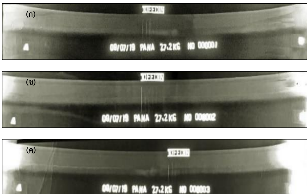
รูปที่ 10 ภาพถ่ายรังสี (ก), (ข), (ค) เชื่อมด้วยตัวแปรควบคุม A*, B และ C ตามลำดับ
