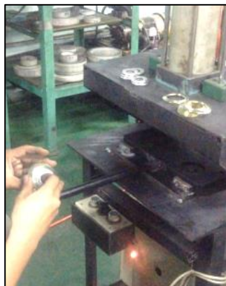
รูปที่ 6 การนำอุปกรณ์ช่วยลดเวลาในการประกอบปะเก็นโลหะ
