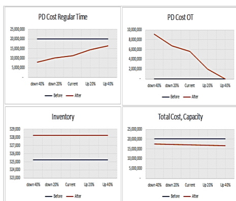
รูปที่ 3 กราฟแสดงต้นทุนแต่ละประเภท เปรียบเทียบก่อนและหลังการหาค่าที่เหมาะสมที่สุด เมื่อปรับค่าพารามิเตอร์ด้านกำลังการผลิตต่อชิ้นต่อชั่วโมง
