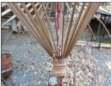
รูปที่ 5 การประกอบค้ำร่มเข้ากับโครง
