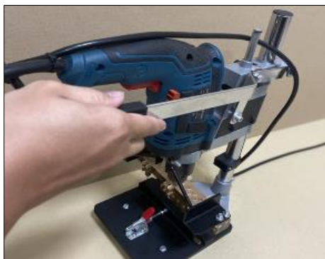
รูปที่ 8 อุปกรณ์ช่วยเจาะรูค้ำริมโบราณที่สร้าง
