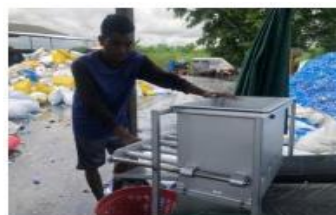
รูปที่ 7 การคัดแยกเศษเหล็กออกจากยางหลังปรับปรุง
