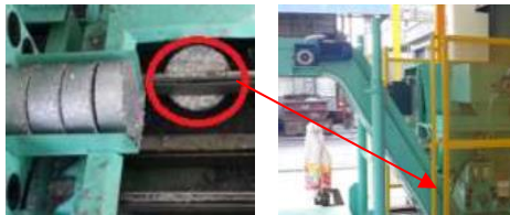
รูปที่ 14 ก่อนอนุมัติเนียมติดช่องสายพานลำเลียง
