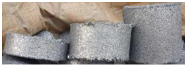
รูปที่ 8 ลักษณะก้อนอลูมิเนียมที่ผ่านการอัดแบบแยกเศษ
