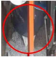
รูปที่ 7 น้ำหล่อเย็นที่ตกค้างในเศษอลูมิเนียม
