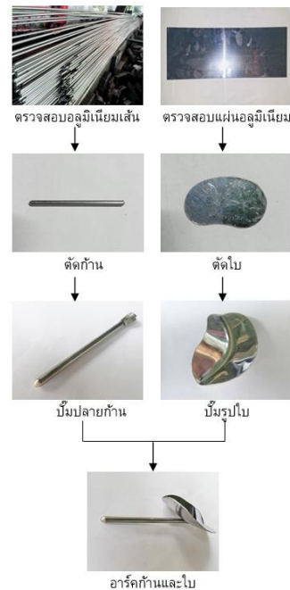
รูปที่ 2 ขั้นตอนการผลิตใบสปริงเกอร์
