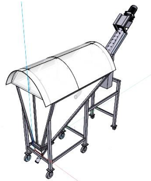
รูปที่ 1 เครื่องอบแห้งข้าวเปลือกพลังงานแสงอาทิตย์ระบบลำเลียงแบบสกรูไม่มีเพลลา
