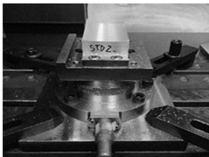
รูปที่ 1 การจับยึดชิ้นงานกับอุปกรณ์จับยึดชิ้นงานและชุดทดสอบแรงตัดเฉือน
