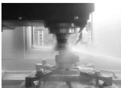
รูปที่ 2 กระบวนการปาดหน้าแบบใช้สารหล่อเย็น
