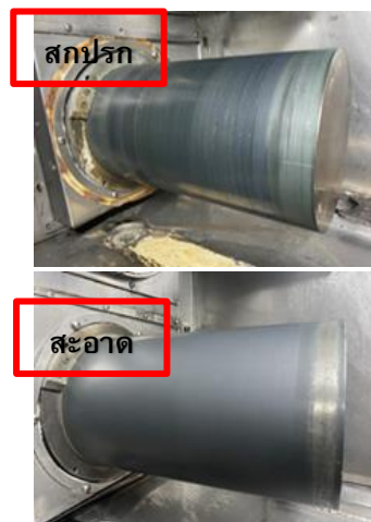
รูปที่ 3 ลูกกลิ้งตึงยัดเส้นด้าย
