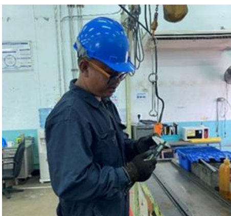
รูปที่ 6 การใช้ Vernier วัดชิ้นส่วนประกอบ Pack
