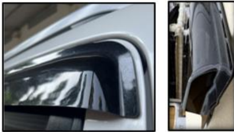
รูปที่ 1 ปัญหาผิวชิ้นงานไม่สวยและเป็นรอยคลื่นของตัวกัน สาดแบบเดิม (OEM)
