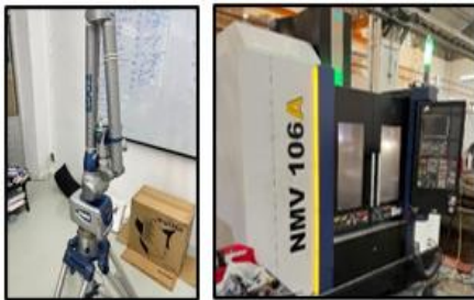
รูปที่ 7 เครื่องมือ-เครื่องจักรที่ใช้ในกระบวนการออกแบบและพัฒนาผลิตภัณฑ์ (เครื่องสแกน 3 มิติและเครื่อง CNC)
