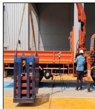
รูปที่ 5 การทดสอบบ้นจั่นในพื้นที่ที่มีแสงสว่างมาก
