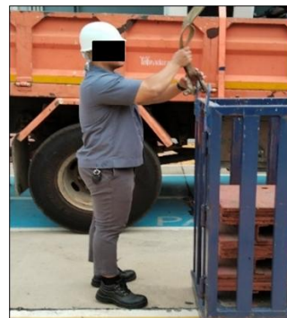
รูปที่ 2 ขั้นตอนการเรียงโหลดเซลล์และผูกมัดอุปกรณ์ยก
