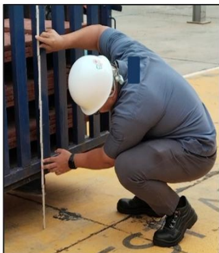
รูปที่ 4 ขั้นตอนการวัดความสูงโหลดเซลล์
