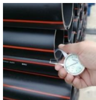
รูปที่ 14 เครื่องมือวัดความหนาต่อ ความละเอียด 0.05 มิลลิเมตร
