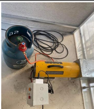
รูปที่ 3 แสดงระบบความร่อนเสริมลมร่อนจาก LPG
