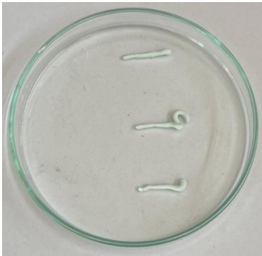
รูปที่ 1 การหาอัตราส่วน P/L ที่เหมาะสมสำหรับการฉีดขึ้นรูป CPC
