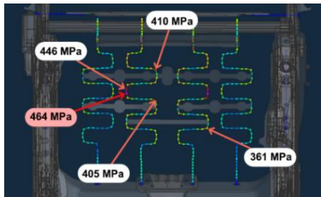
รูปที่ 8 การจำลองการรับแรงของสปริงช็อกแชก
