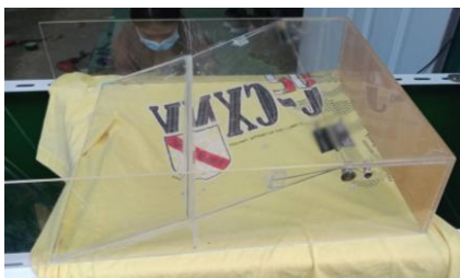
รูปที่ 2 ลักษณะทางลาดเอียงพร้อมแผ่นกระดกสำหรับคัดแยกขวดพลาสติกและขวดแก้ว
