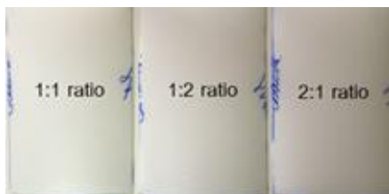
รูปที่ 8 ตัวอย่างชิ้นงานทดสอบ HDPE ที่ได้จากการขึ้นรูปด้วยอัตราส่วนผสมของเม็ดพลาสติกใหม่ต่อพลาสติกกรีไซเคิล 1:1, 1:2 และ 2:1
