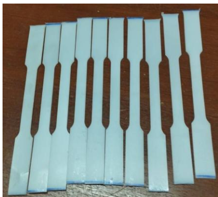
รูปที่ 9 ตัวอย่างชิ้นงานทดสอบแรงดึงที่เตรียมจากขวดน้ำพอลิเอทิลีนความหนาแน่นสูง (HDPE) ขนาด 20 ลิตร
