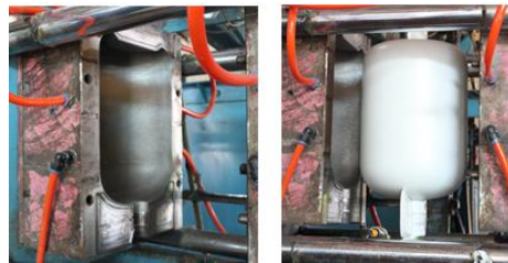
รูปที่ 2 ตัวอย่างการขึ้นรูปขวดน้ำจากเม็ดพลาสติก HDPE ด้วยกระบวนการเป่าขึ้นรูป (Blow Molding)
