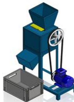
รูปที่ 3 แบบจำลองการออกแบบเครื่องบดพลาสติก HDPE
