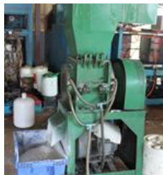
รูปที่ 4 เครื่องบดพลาสติก HDPE ต้นแบบที่ใช้สำหรับย่อยเศษพลาสติกจากกระบวนการผลิต
