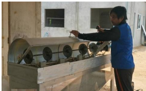
รูปที่ 5 พนักงานใช้เครื่องตัดท่อนพันธุ์มันสำปะหลัง (หลังปรับปรุง)
