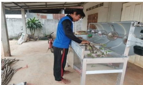
รูปที่ 3 การทดสอบใช้เครื่องตัดท่อนพันธุ์มันสำปะหลัง
