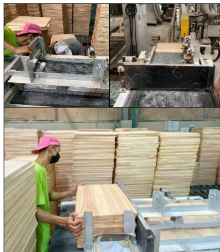
รูปที่ 6 การติดตั้งและการทดสอบชุดป้อนอัตโนมัติ
