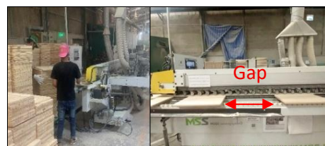
รูปที่ 1 ช่องว่าง (Gap) ระหว่างชิ้นงานบนสายพานลำเลียง เกิดจากความเมื่อยล้าสะสมของแรงงานคน
