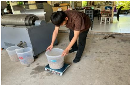
รูปที่ 2 เครื่องคัดแยกขนาดเมล็ดกาแฟโรบัสต้ากิ่งอัตโนมัติที่สร้างจริง และการเก็บตัวอย่างเมล็ดกาแฟสำหรับชั่งน้ำหนักในการทดลอง
