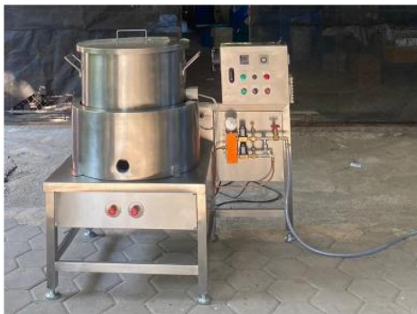
รูปที่ 11 ระบบต้มน้ำอัตโนมัติพร้อมระบบส่งข้อมูลผ่านแอปพลิเคชันที่ผลิตแล้วเสร็จ
