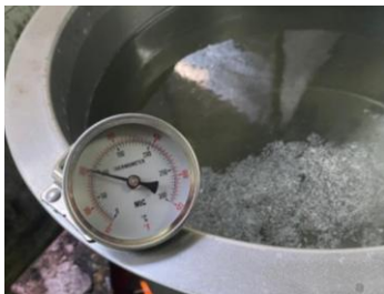
รูปที่ 6 การวัดอุณหภูมิหม้อต้มแบบเดิม
