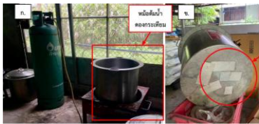
รูปที่ 2 (ก.) ลักษณะของการตั้งเตา ก่อนปรับปรุง (ข.) หม้อชำรุด
