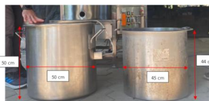
รูปที่ 9 การเปรียบเทียบหม้อต้มใบใหม่(ซ้าย) และหม้อ ต้มใบเก่า(ขวา)
