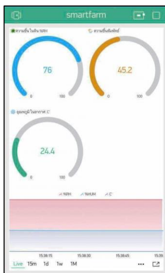
ภาพที่ 6 ผลการแสดงอุณหภูมิความชื้นและความชื้นในดินบนอุปกรณ์เคลื่อนที่
