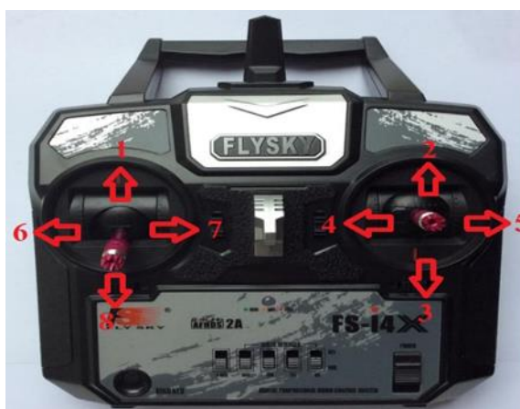
ภาพ 3 ภาพแสดงวิธีควบคุมหุ่นยนต์ซูโม่บังคับด้วยรีโมทแบบไร้สาย
