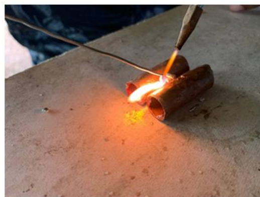
ภาพที่ 4 ลักษณะของชิ้นงานที่ได้รับการเชื่อมบัดกรี
