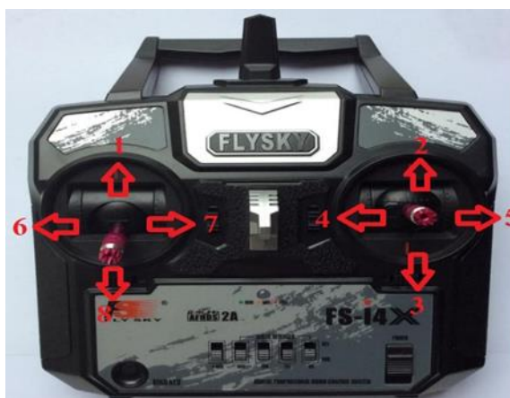
ภาพ 3 วิธีควบคุมหุ่นยนต์ซูโมบังคับด้วยรีโมทแบบไร้สาย
