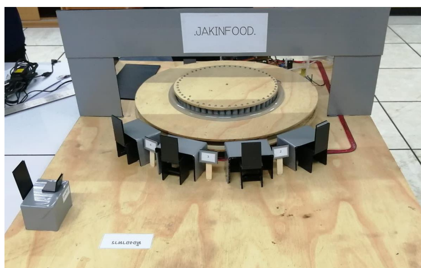
ภาพที่ 3 แบบจำลองร้านอาหารสายพานควบคุมด้วยเทคโนโลยีสมองกลฝังตัว
