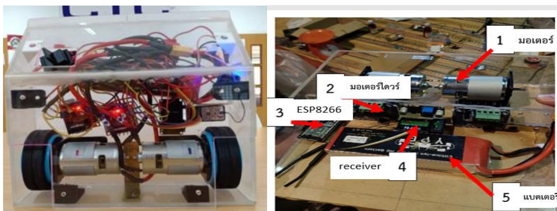
ภาพที่ 7 องค์ประกอบของหุ่นยนต์ซูโม่บังคับแบบรีโมทด้วยเทคโนโลยีไร้สาย
