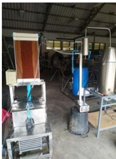
ภาพที่ 4 เครื่องกลั่นน้ำมันหอมระเหยควบคุมด้วยระบบปิด
