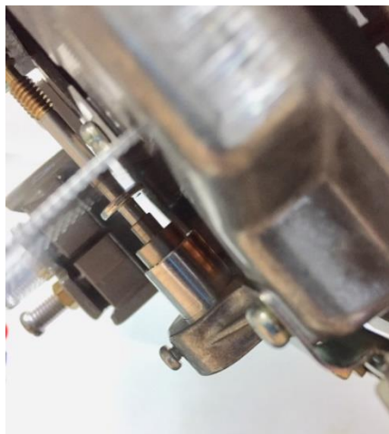
รูปที่ 4 ลักษณะแกนหมุนของจานมิเตอร์ขณะเอียง
