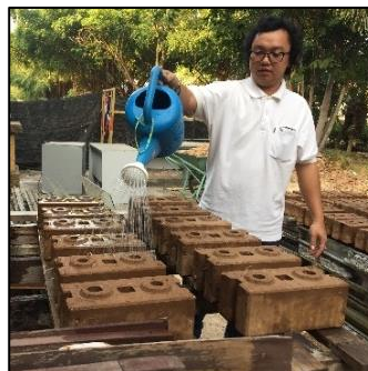
(ฉ) รดน้ำอิฐบล็อกประสาน
