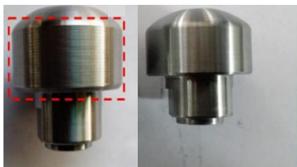
รูปที่ 10 (ซ้าย) ชิ้นงานมี \varnothing 31 mm ผิวลายก่อนปรับปรุง (ขวา) ชิ้นงานที่ไม่เกิดปัญหา \varnothing 31 mm ผิวลาย หลังปรับปรุง
