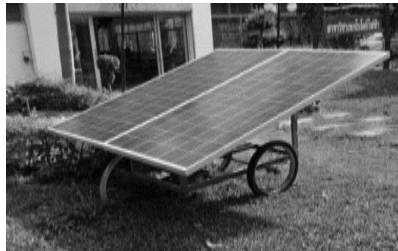
รูปที่ 3 แผงเซลล์แสงอาทิตย์ยี่ห้อ JETION ขนาดกำลังไฟฟ้า 300W และยี่ห้อ LARLAND ขนาดกำลังไฟฟ้า 280W
