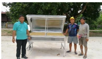
รูปที่ 8 การทดลองใช้โดมอบเมล็ดพันธุ์ข้าวด้วยพลังงานแสงอาทิตย์
