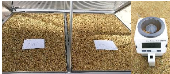
รูปที่ 9 ผลการทดลองวัดค่าความชื้นเมล็ดข้าวจากโดมอบเมล็ดพันธุ์ข้าวพลังงานแสงอาทิตย์
