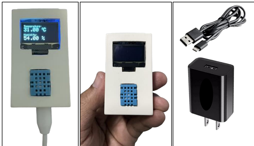
รูปที่ 5 เครื่องบันทึกเพื่อตรวจติดตามอุณหภูมิและความชื้นสัมพัทธ์ในโรงเลี้ยงไหมพันธุ์พื้นบ้าน
