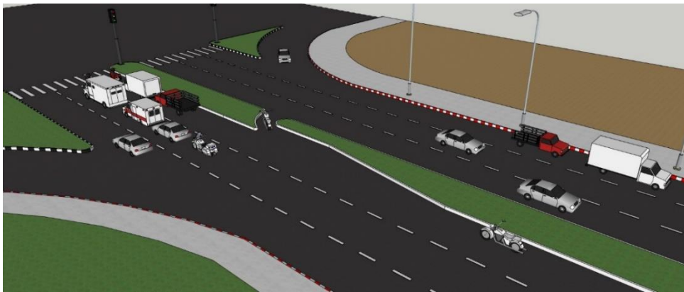
รูปที่ 10 การออกแบบจุดกลับรถเฉพาะรถจักรยานยนต์ (แบบ 3 มิติ)
