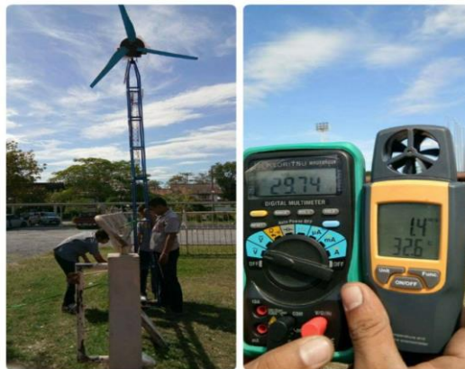
รูปที่ 13 การทดสอบแรงดันไฟฟ้าบริเวณสนามกีฬามหาวิทยาลัยราชภัฏบุรีรัมย์ของกังหันลมแกนนอน
