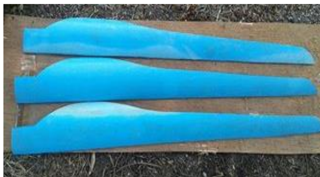
รูปที่ 3 ลักษณะการออกแบบใบพัดกังหันลมแบบแกนนอน
