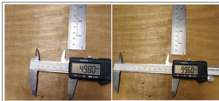
รูปที่ 8 การเคลื่อนที่ในรูปแบบสี่เหลี่ยมจัตุรัส จุดเริ่มต้น ที่ 50 และ 100 มม. ในทิศทาง X และ Y
