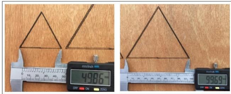
รูปที่ 9 การเคลื่อนที่ในรูปแบบสามเหลี่ยมด้านเท่า จุดเริ่มต้น ที่ 50 และ 100 มม. ในทิศทาง X และ Y
