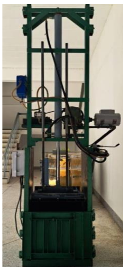
รูปที่ 7 เครื่องปั๊มอัดขยะขนาดเล็กควบคุมด้วยระบบไฮดรอลิก
