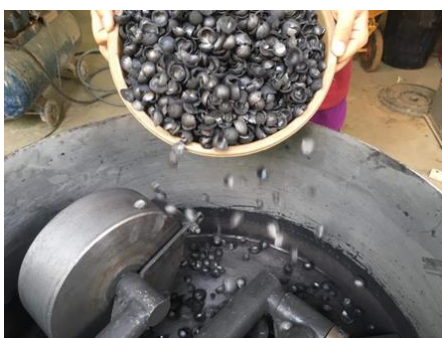
รูปที่ 3 การบดถ่านเปลือกเมล็ดแมคคาเดเมียด้วยเครื่องบด
