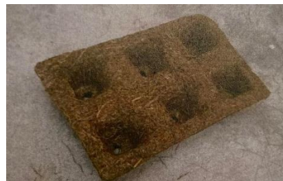
รูปที่ 16 การทดสอบความแข็งแรงของถาดปลูกพืชจากมูลช้างโดยการโยนจากที่สูง
