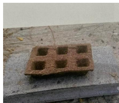
รูปที่ 17 การทดสอบความแข็งแรงของถาดปลูกพืชจากมูลช้างโดยกดทับ
