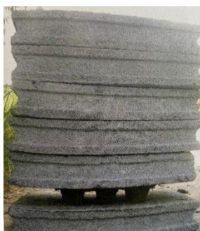
รูปที่ 17 การทดสอบความแข็งแรงของถาดปลูกพืชจากมูลช้างโดยกดทับ
