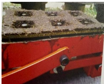
รูปที่ 12 การกดคั่นโยกเพื่อยกแม่พิมพ์ออกจากเครื่องอัด
