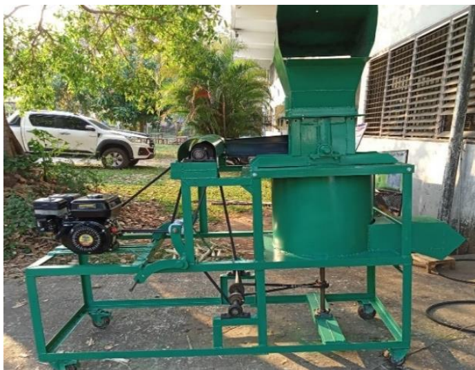
รูปที่ 4 เครื่องตัดย่อยผักตบชวาที่สมบูรณ์
