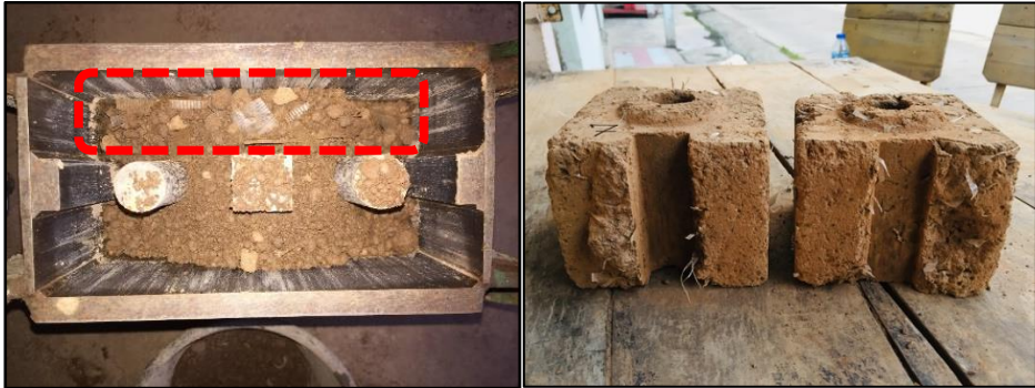
รูปที่ 7 ชื้นงานเกิดเป็นโพรงเนื่องจากเศษพลาสติกที่ไปกองรวมกันอยู่ที่ด้านใดด้านหนึ่ง
