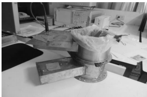
รูปที่ 3 สายอากาศในการทดลองโดยมีสายโพรบเป็นสายวัดที่ต่อเข้ากับ Network Analyzer
