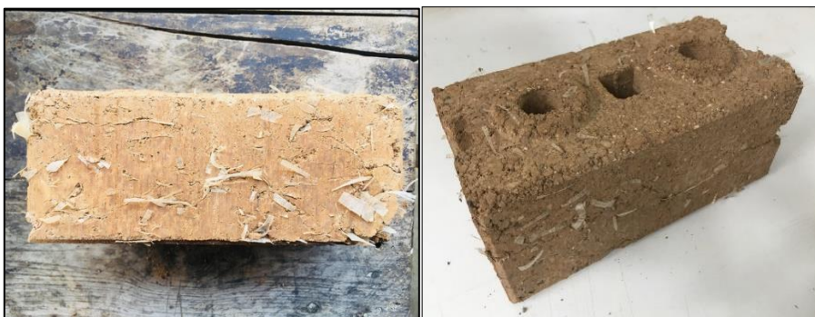
รูปที่ 8 ผิวสัมผัสอิฐบล็อกประสานไม่เรียบเกิดช่องว่างและโพรงในบล็อกประสาน
