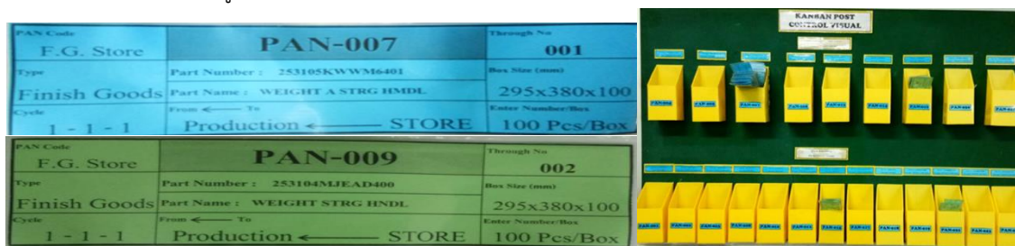
รูปที่ 11 บัตร Kanban สั่งผลิตชิ้นงาน WH-6400 และ กล่องใส่บัตร Kanban Post Production
