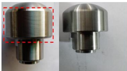
รูปที่ 10 (ซ้าย) ชิ้นงานมี \varnothing 31 mm ผิวลายก่อนปรับปรุง (ขวา) ชิ้นงานที่ไม่เกิดปัญหา \varnothing 31 mm ผิวลาย หลังปรับปรุง
