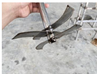
9) ทำการเปลี่ยนชุดใบมีดจากแบบตรงเป็นชุดใบมีดแบบโค้ง
