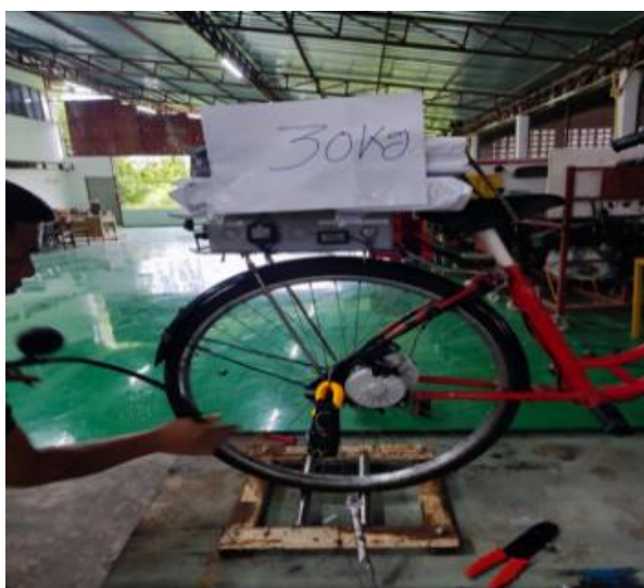
รูปที่ 3 การทดลองภาระโหลดที่น้ำหนัก 30 กิโลกรัม
