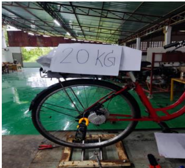
รูปที่ 4 การทดลองภาระโหลดที่น้ำหนัก 20 กิโลกรัม
