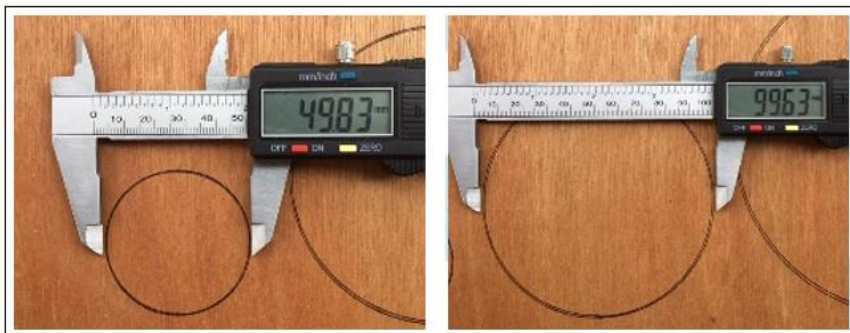
รูปที่ 10 การเคลื่อนที่ในรูปแบบวงกลม จุดเริ่มต้น ที่ 50 และ 100 มม. ในทิศทาง X และ Y
