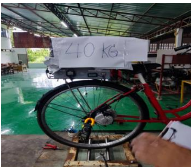
รูปที่ 2 การทดลองภาระโหลดที่น้ำหนัก 40 กิโลกรัม
