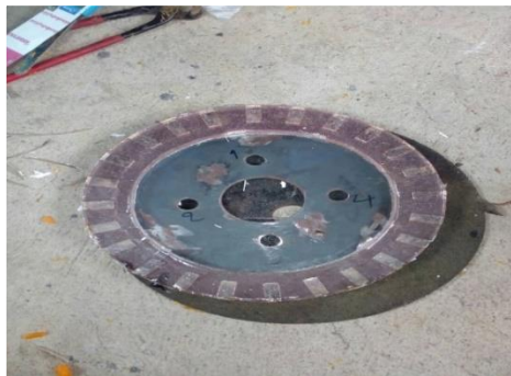
รูปที่ 6 เครื่องกำเนิดจากจานแม่เหล็กถาวรที่หล่อเสร็จแล้ว
