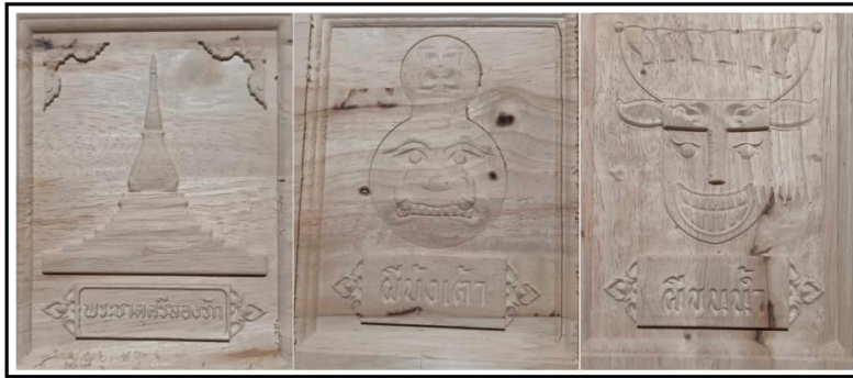
รูปที่ 11 ผลลัพธ์ที่ได้จากการจากการพัฒนาเครื่องแกะสลักไม้เพื่อสร้างชิ้นงานแบบไทย
